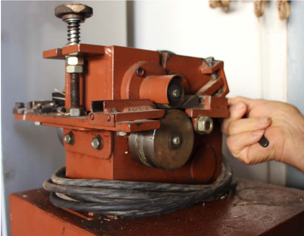
Abb. 33: Das Einstellen der Weidenhobelmaschine (v. K. Jüttner)
