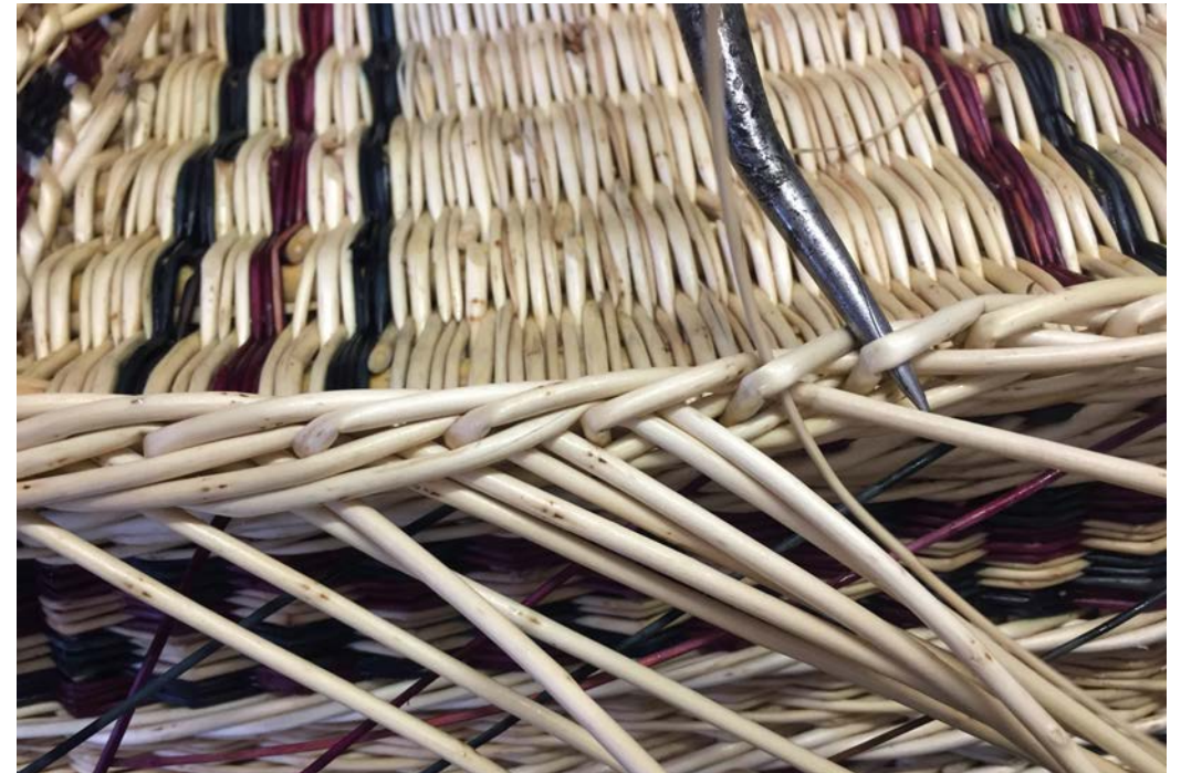
Abb. 50: Der Zuschlag des Fußes wird verzogen. Dazu wird mit dem Pfriem vorgestochen. (v. K. Jüttner)
