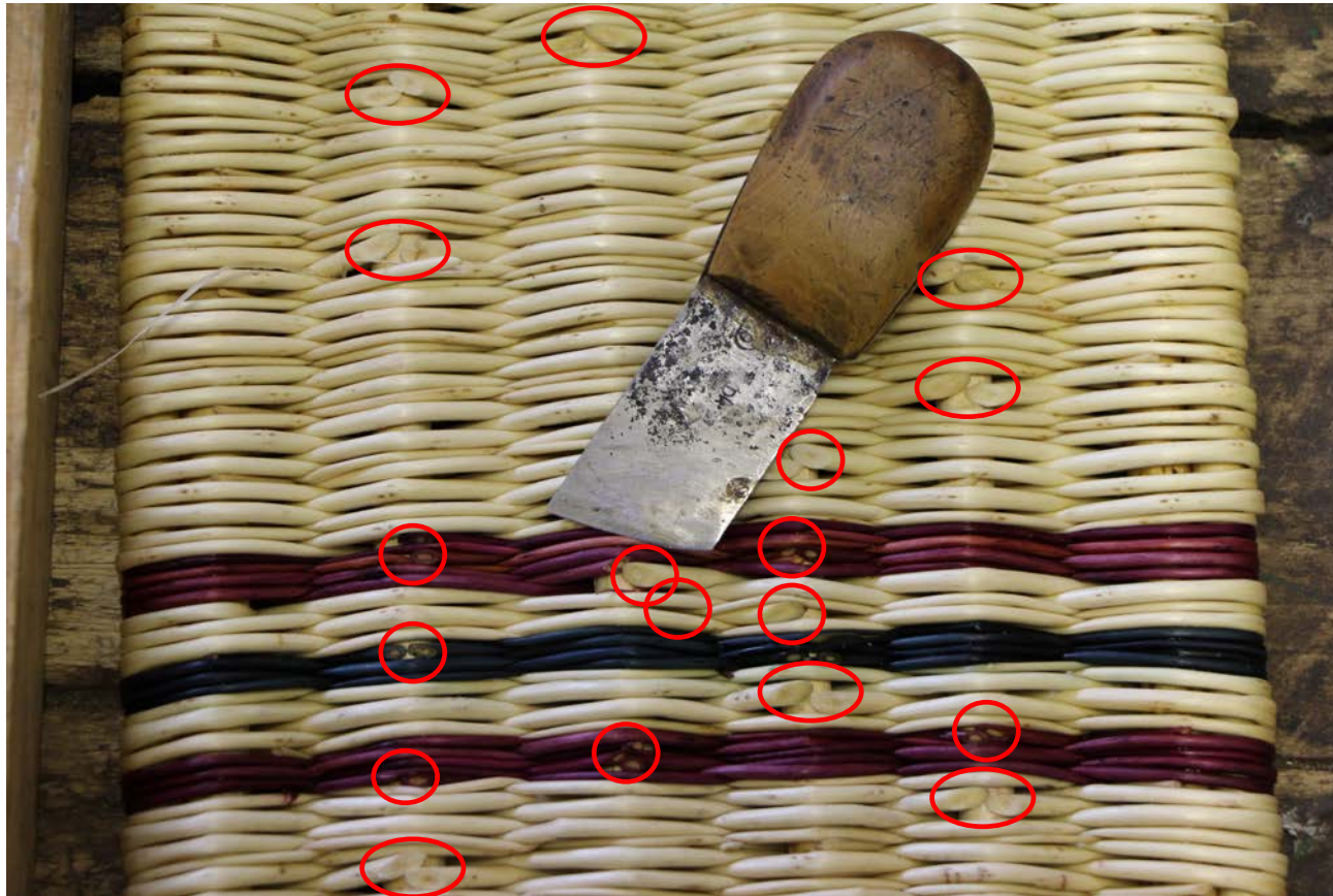
Abb. 39: Der fertige Boden wird mit dem Ausstecher „geputzt“, (v. K. Jüttner)
