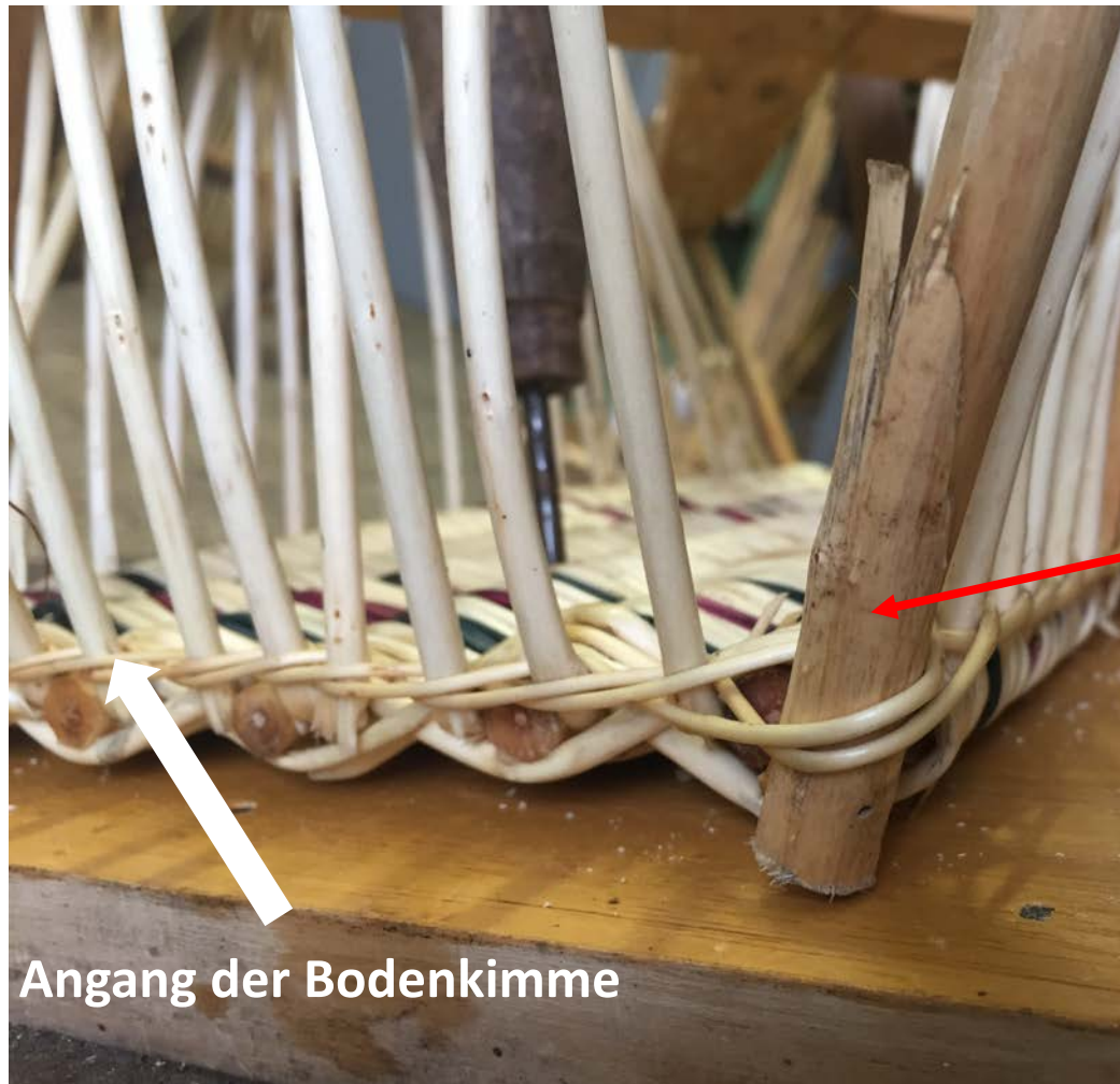
Abb. 47: Mit der Bodenkimme werden die Staken u. Eckstöcke gerichtet d.h. in Position gebracht. Gleichzeitig wurde je Eckstock ein Platzhalterkeil (grün) für die Eckstöcke des Fußes eingeflochten. (v. K. Jüttner)
