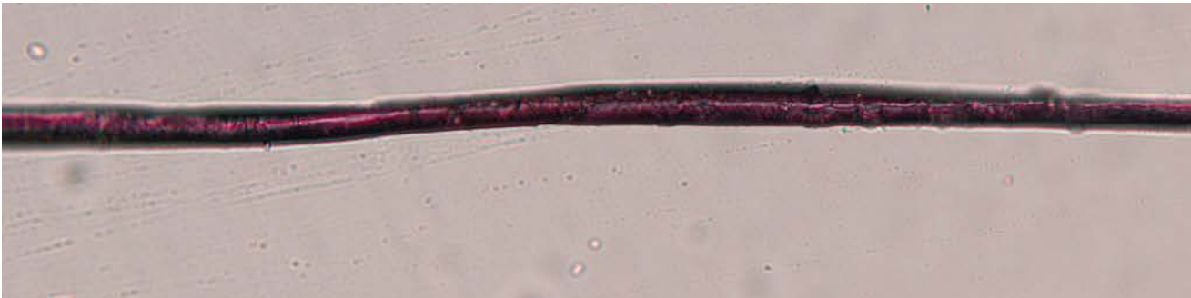
Abb. 24: Lichtmikroskopische Aufnahme Nr. 1: Seide – Bodderkorf MEK, Durchlicht, Hellfeld, parallele Polarisierung, (v. K. Jüttner)
