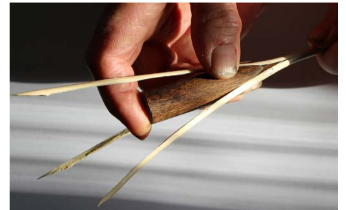
Abb. 32: Spalten mit dem dreiteiligen Reißer, (v. K. Jüttner)
