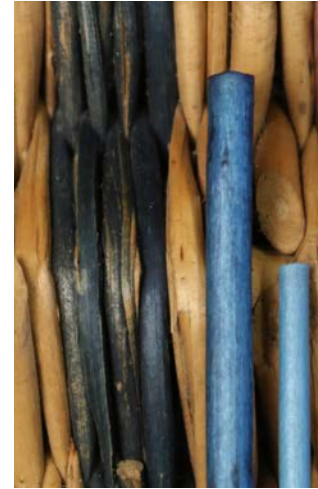
Abb. 35: Links: blau gefärbte Weiden original, Mitte: Probe Indigo gefärbt (Versuch Nr. 2), Rechts: Probe Indigo gefärbt (Versuch Nr. 2) nach 24 Stunden in Wasser, (v. K. Jüttner)
