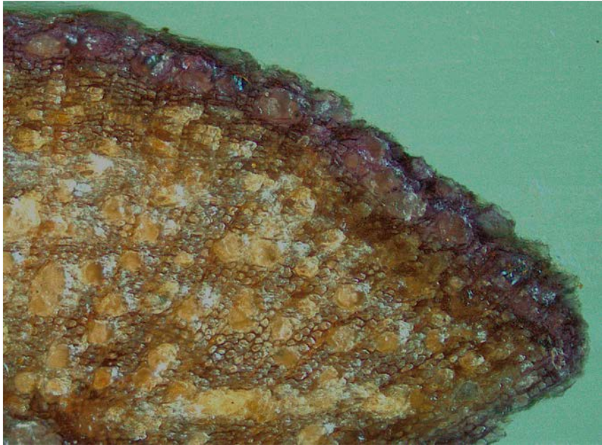
Abb. 26: Querschliff Weide violett gefärbt – 10-fache Vergrößerung, Aufnahme im Dunkelfeld, (v. K. Jüttner)
