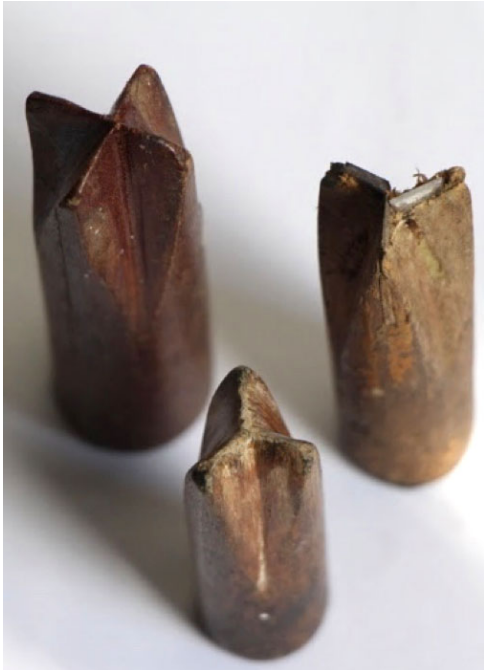
Abb. 28: vierteiliger Reißer (Links), dreiteiliger Reißer (Mitte) u. dreiteiliger Reißer mit Metallschneide (Rechts) / (v. K. Jüttner)
