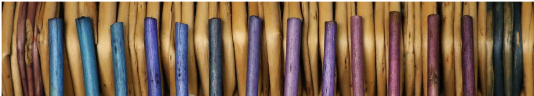
Abb. 35: Links: blau gefärbte Weiden original, Mitte: Probe Indigo gefärbt (Versuch Nr. 2), Rechts: Probe Indigo gefärbt (Versuch Nr. 2) nach 24 Stunden in Wasser, (v. K. Jüttner)
