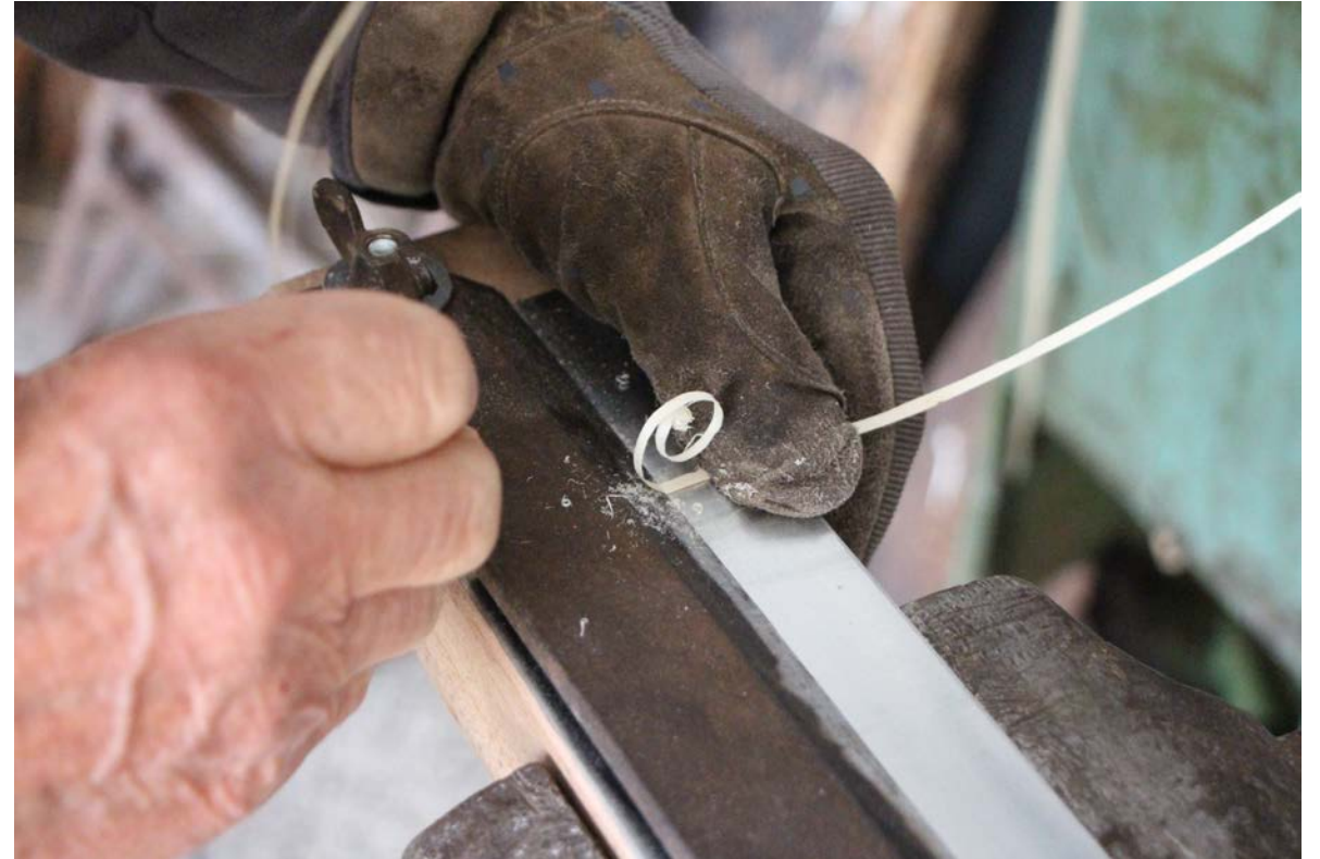
Abb. 34: Die Arbeit mit dem Weidenhandhobel (eingespannt im Schraubstock) für besonders dünne Schienen (v. K. Jüttner)
